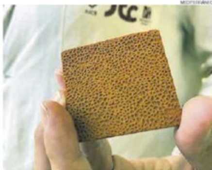
Pieza de cerámica con relieves hechos gracias a la técnica de la impresión 3D.
